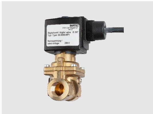
Das Spülgasventil schaltet die Spülgaszufuhr. Es ist ein vorgesteuertes Magnetventil und dient zur Einleitung des Spülgases in ein überdruckgekapseltes Gehäuse der Zone 2. Hierbei wird das Spülgasventil vom Steuergerät SILAS<sup>pz</sup> so angesteuert, dass das Spülgasventil zur Spülung des überdruckgekapselten Gehäuses öffnet und nach Abschluss der Spülung wieder schließt.
