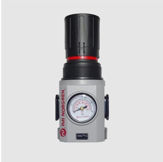
Dieser vorschaltbare Druckminderer ist ein Membrandruckregler mit Sekundärentlüftung zur Druckabsenkung extern gelieferter Spülluft. Die Einstellung erfolgt über ein Handrad. Der eingestellte geminderte Druck kann über ein Manometer abgelesen werden.
